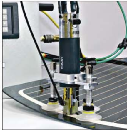
Bild 2: Automatisierter Lötprozess auf Glas
