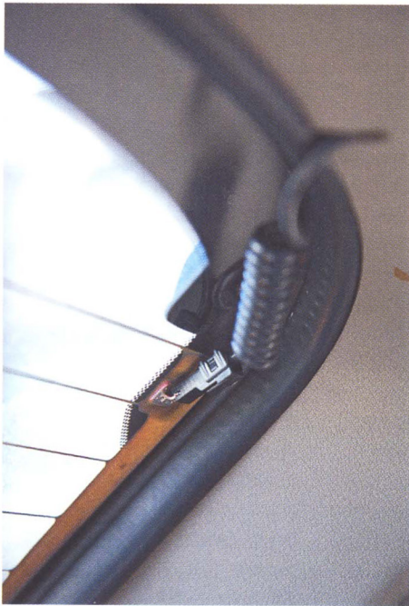
Das Modul, wie es in das Fahrzeug integriert wurde: Heckscheibe mit Anschlusselement und Konnektor für die Verbindung zum Kabelbaum im Fahrzeug
